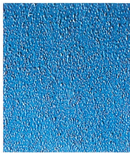
ノンスリップ処理後塗膜表面
